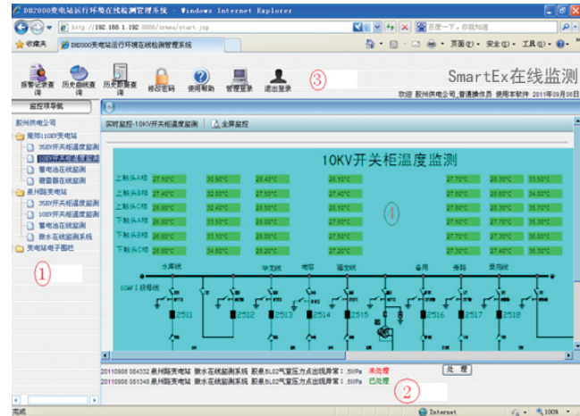
开关柜温度监测画面
